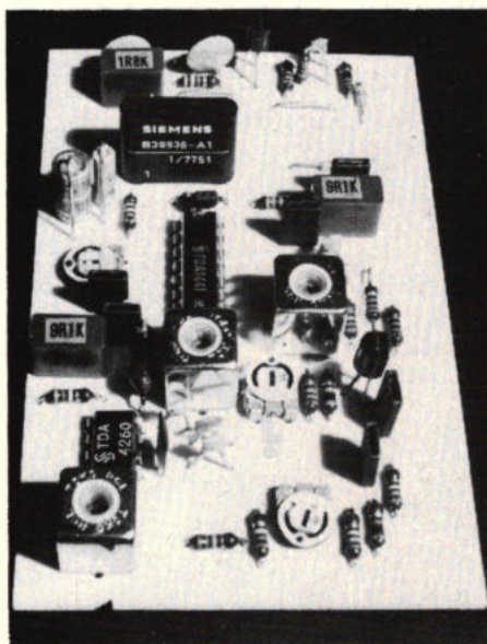
Afb. 17. Oppervlaktegolf-filter B39936 op lithiumniobaat-substraat voor de beeld-middenfrequenttrappen in TV-ontvangers (Siemens).
