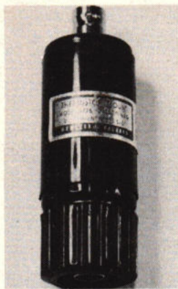
Afb. 2. Bolometer type HP-477B voor metingen van 10 MHz tot 10 GHz.
